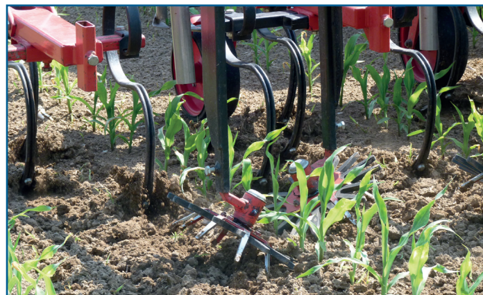
Vingerwieders pakken kleine en pas ontkiemde onkruiden in de gewasrij aan. De 'vingers' zijn flexibel en beschadigen het gewas niet.
