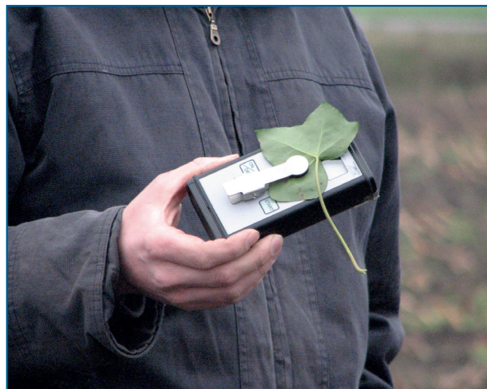
De MLHD-meter ziet of het onkruid dood gaat, voordat dit met het blote oog zichtbaar is
