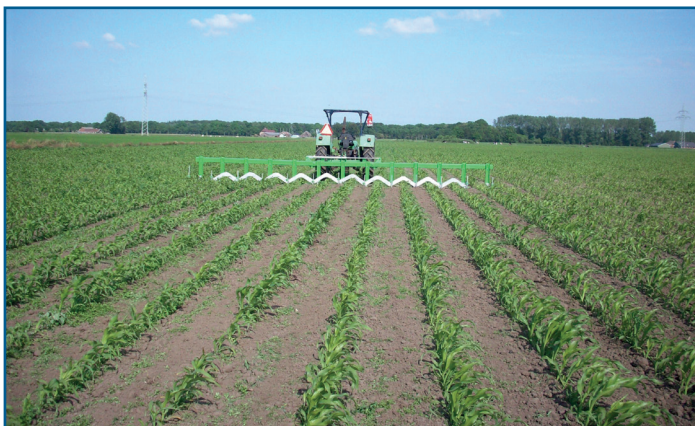
Gewasgeleide schoffels worden gestuurd door de gewasrij. Dit kan zelfs in kleine, tere gewassen, mits de gewasrij vrij recht is.
