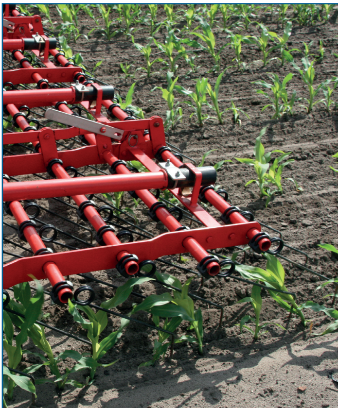
De veertandeg gaat onkruid te lijf met zijn lange, dunne en flexibele veertanden.
