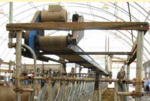
Amerika: voerband brengt voer op smal voerpad
